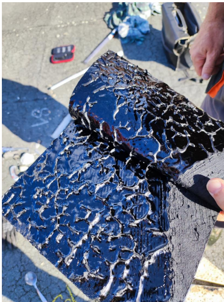
Obrázek č. 8 – Projev natavení horního pásu na mokrý podkladní pás
